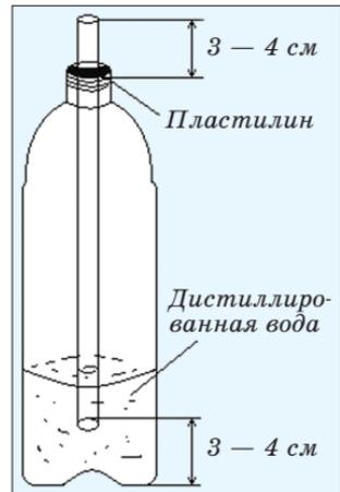
Работает прибор так. Если стеклянная трубка заполнена воздухом, значит, ближайшие 2 — 3 дня погода, скорее всего, будет хорошей. Ну, а если через верх трубки вытекают капли воды, ждите ненастья.
