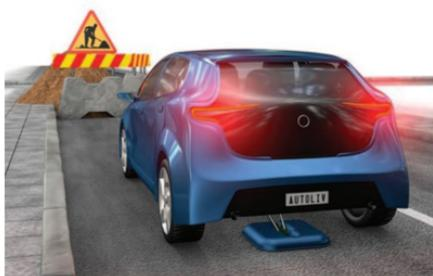
**Монтаж вакуумной пластины к днищу автомобиля.**
