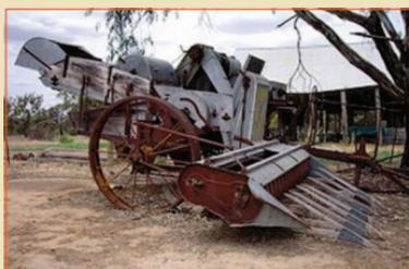
В 1890 году производством комбайнов занимались уже 6 фирм. Передвижение комбайна по полю осуществлялось в основном лошадьми и мулами, причем иной раз требовалось до 40 натуральных лошадиных сил. Рабочие органы приводились в движение с помощью передач от ходовых колес, а с 1889 года — от паровой машины.
